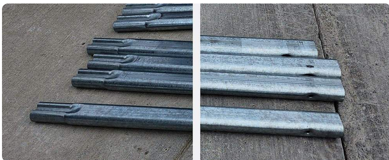
Les 2 bouts d'une patte : le bout étroit à gauche, le bout large avec le trou à droite
